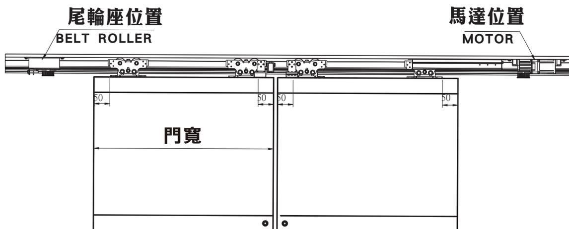
二側吊滑輪座按裝時須與門扇邊緣距離約 50mm，
